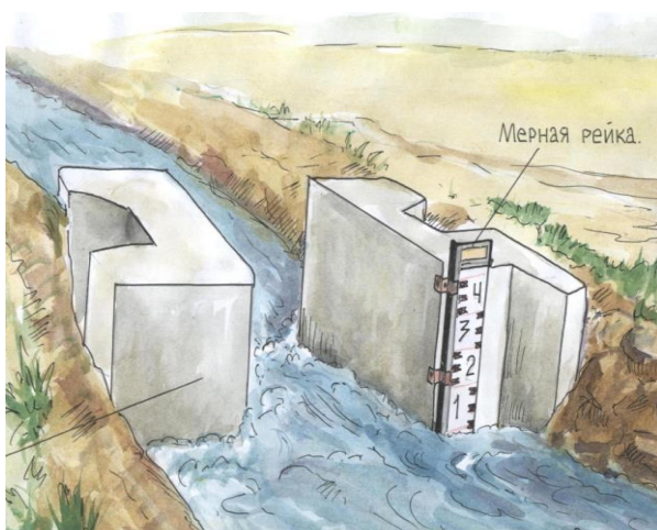
Рис.4. Водомерный лоток САНИИРИ (ВЛС)
