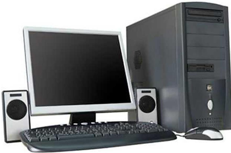
**Системный блок** – металлический корпус с технологическими отверстиями под устройства, кнопкой включения и световыми индикаторами, в котором размещаются все основные комплектующие компьютера (материнская плата, процессор, жесткий диск, оптический привод и т.д.). Системный блок считается основной частью персонального компьютера, к нему подключаются все остальные устройства.
