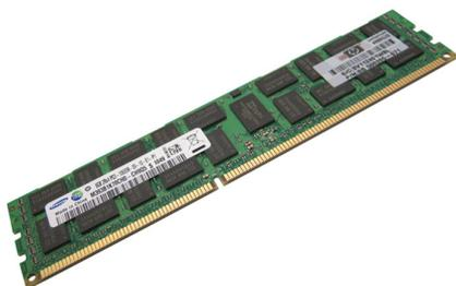
**Оперативная память** или **оперативное запоминающее устройство (ОЗУ)** – память компьютера, в которой во время работы компьютера хранится выполняемый код программ, а также входные, выходные и промежуточные данные, обрабатываемые процессором.
