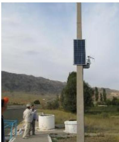
Фото 2: новые установленные датчики на магистральном канале
